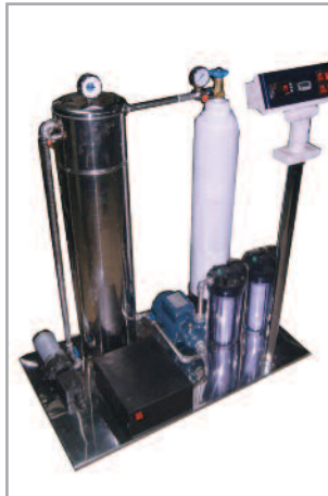
راکتور ترکیبی تصفیه گر شهری بدون تولید لجن
